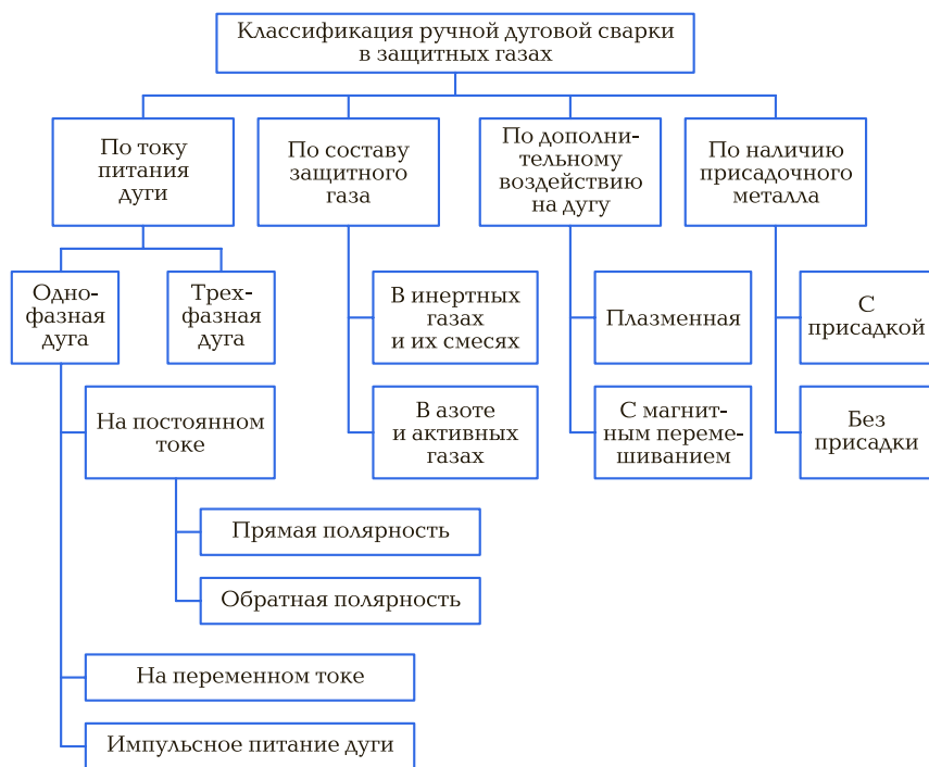
Рис. 2.15. Классификация методов сварки в защитных газах
