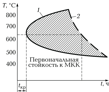
Рис. 1.17. Зависимость появления склонности к межкристаллитной коррозии металла шва на аустенитной стали от температуры T и времени t
