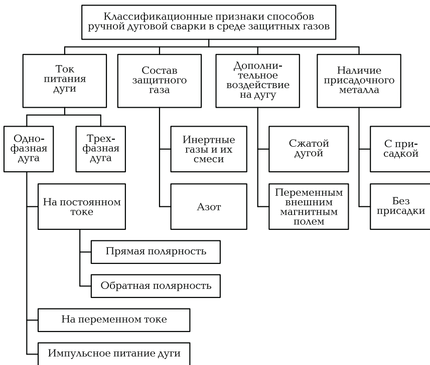
Рис. 1.24. Систематизация классификационных признаков способов ручной дуговой сварки плавящимся электродом в среде защитных газов
