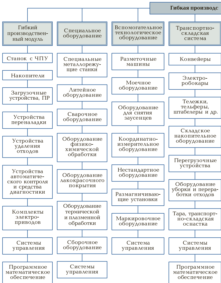
Рис. 23.3. Обобщенная структурная схема элементов и подсистем гибкой
