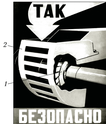
Рис. 9.1. Ограждение фрезы на горизонтально-фрезерном станке: 1 — фреза; 2 — ограждение
